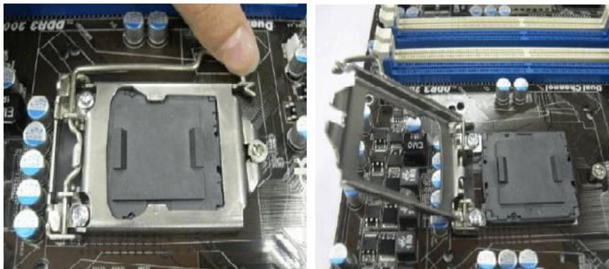
**Fase 2. Rimuovere il coperchio di protezione della CPU:** Fissare il dito indice al bordo superiore del coperchio PnP. Usare il pollice per rimuovere il coperchio PnP (il coperchio Pick and Place) dal socket della CPU sollevando la linguetta del cappuccio.
