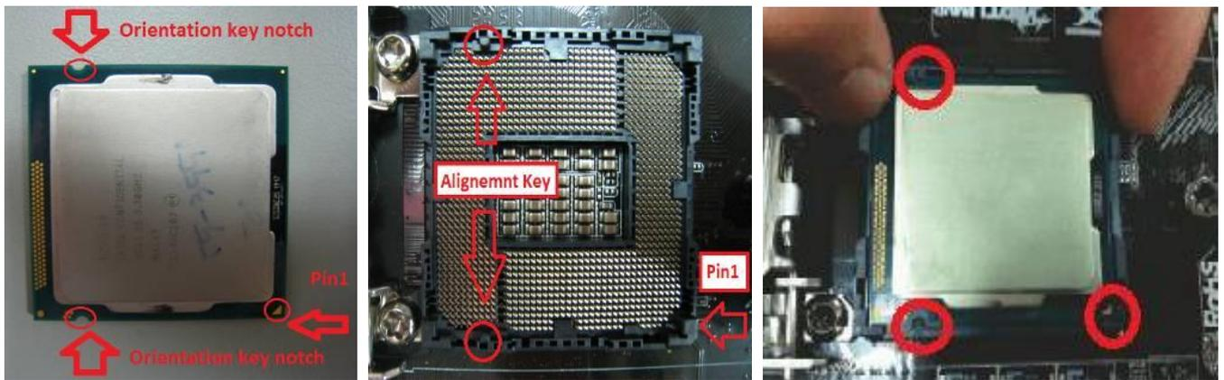
**Fase 4. Chiudere il socket:** premere verso il basso la leva di caricamento e fissarla con la linguetta della piastra di carico sotto la linguetta di blocco.
