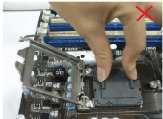
NON rimuovere il coperchio PnP come appare qui sotto. La rimozione non corretta del coperchio PnP potrebbe danneggiare i contatti del socket della CPU.
