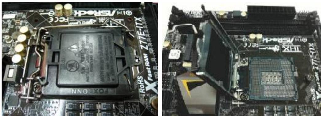
**Fase 2. Inserire la CPU a 1155 Pin:** Assicurarsi di individuare il Pin1 ed i due dentelli di orientamento, quindi posizionare accuratamente la CPU nel socket.
