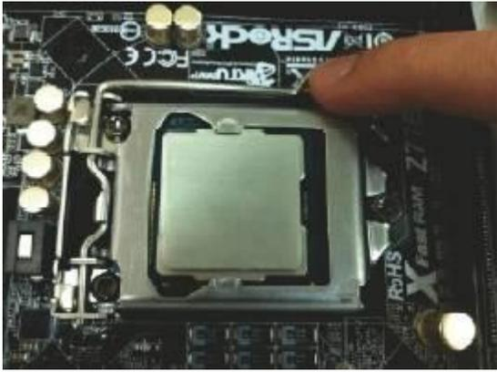
**Tipo B: Copertura di protezione della CPU nel socket CPU.**
