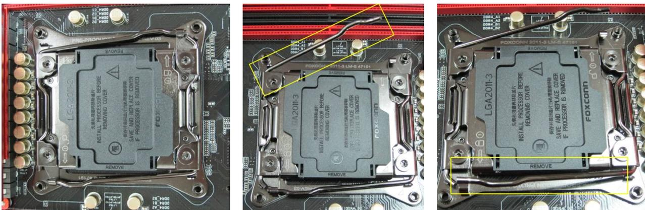
Passo 2. **Insira a CPU LGA 2011-3:** Certifique-se de posicionar o Pino1 e os dois chanfros de orientação em seus devidos lugares e então coloque cuidadosamente a CPU no soquete.
