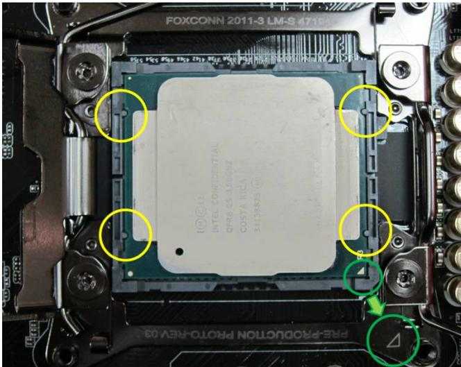
**Passo 3. Feche o soquete:** Pressione as alavancas para baixo em ambos os lados e prenda-as sob a aba de retenção. A capa de proteção sairá automaticamente.
