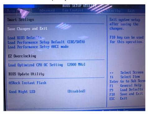
Если вы переключите функцию "Good Night LED" в состояние [Enabled], система будет выключать светодиоды.
